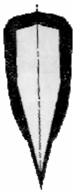
Rys.7 Rozkład glinki ( yakiba-tsuchi ) na przekroju głowni.
